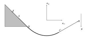
una forza f di modulo  $\sqrt{2}p\ell$  applicata in A. Il piano inclinato è scabro ed il contatto con il filo è caratterizzato da un coefficiente di attrito statico  $\mu$ . Scrivere l'equazione del profilo libero BC rispetto ad assi ortogonali  $\{e_x, e_y\}$  centrati nel vertice del tratto BC; determinare i valori di  $\mu$  compatibili con l'equilibrio; calcolare il dislivello tra i punti B e C.
