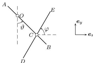
L'asta  $AB$  ruota attorno al punto  $O$  fisso con velocità angolare  $\omega_{AB} = \dot{\vartheta}e_z$  ed ha pertanto momento della quantità di moto rispetto ad  $O$
