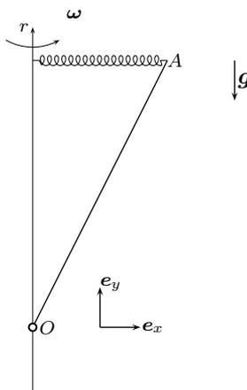
Indichiamo con  $\vartheta$  l'angolo compreso tra  $r$  e l'asta. Dobbiamo discutere la stabilità della configurazione di equilibrio in cui  $\vartheta = 0$ . Nel sistema rotante occorre considerare i contributi all'energia potenziale dovuti alla forza peso, alla molla
