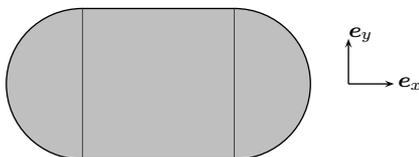
Per simmetria materiale, il centro di massa della lamina coincide con il centro del quadrato. Se osserviamo che, traslando idealmente i due semidischi nella direzione  $\mathbf{e}_x$  fino a farne coincidere i diametri non cambia il momento di inerzia
