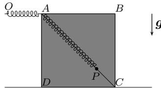
Usiamo come coordinate lagrangiane l'ascissa di  $A$  rispetto ad  $O$  e la distanza  $s \in [0, \ell\sqrt{2}]$  di  $P$  da  $A$ . L'energia potenziale  $V$  è data da
