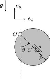
una rotazione attorno all'asse passante per  $O$ , diretto lungo  $e_z$ , con velocità angolare  $\omega = \dot{\vartheta}e_z$  per cui,
